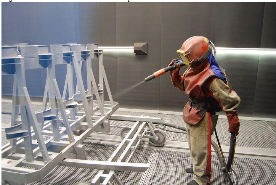
Figura 1 – Jateamento com a utilização de elementos abrasivos
